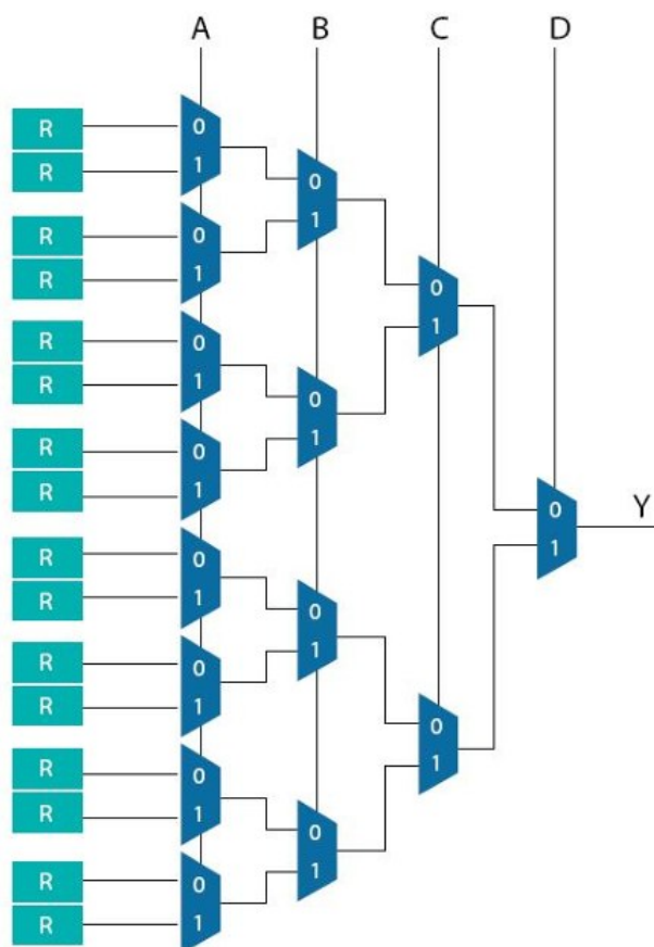
Рисунок 1.2 – Логічна структура блоків LUT FPGA [70]
