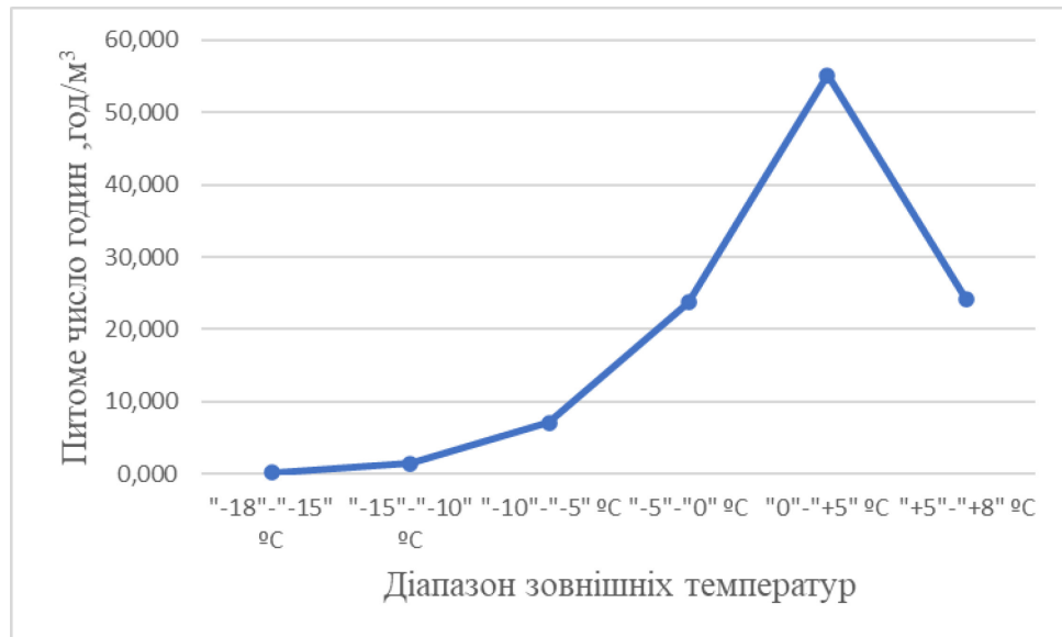
Рисунок 2.14 – Залежність питомих годин використання акумулюючого середовища від температурних діапазонів зовнішнього повітря для житлового будинку
