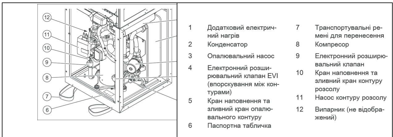
Рисунок 4.4 – Принципова схема улаштування (а) та компонентів (б) теплового насоса flexoTHERM exclusive VWF [109]
