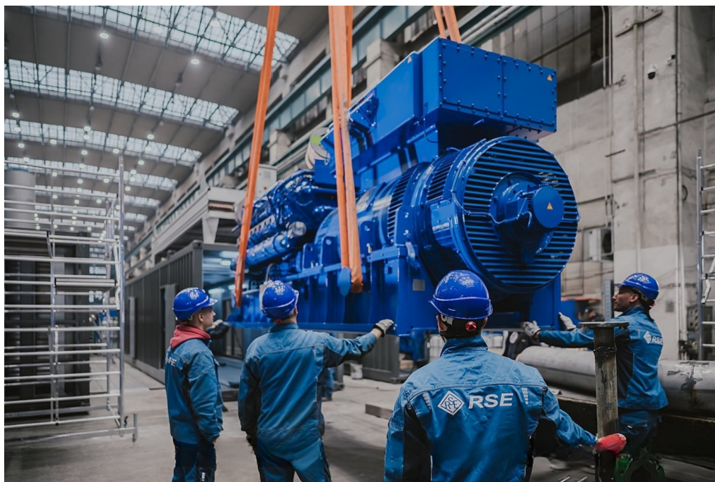
Рисунок. 1.3 – Зовнішній вигляд когенераційної установки фірми «RSE», Чехія
