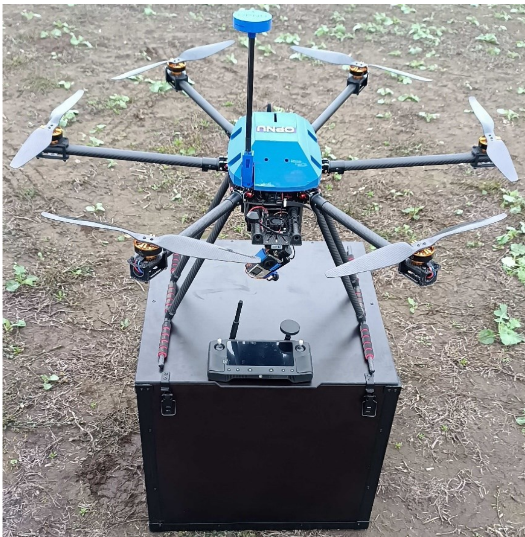
Рисунок 2.1 – Розроблений гексакоптер у готовому до польоту стані [5, 60]
