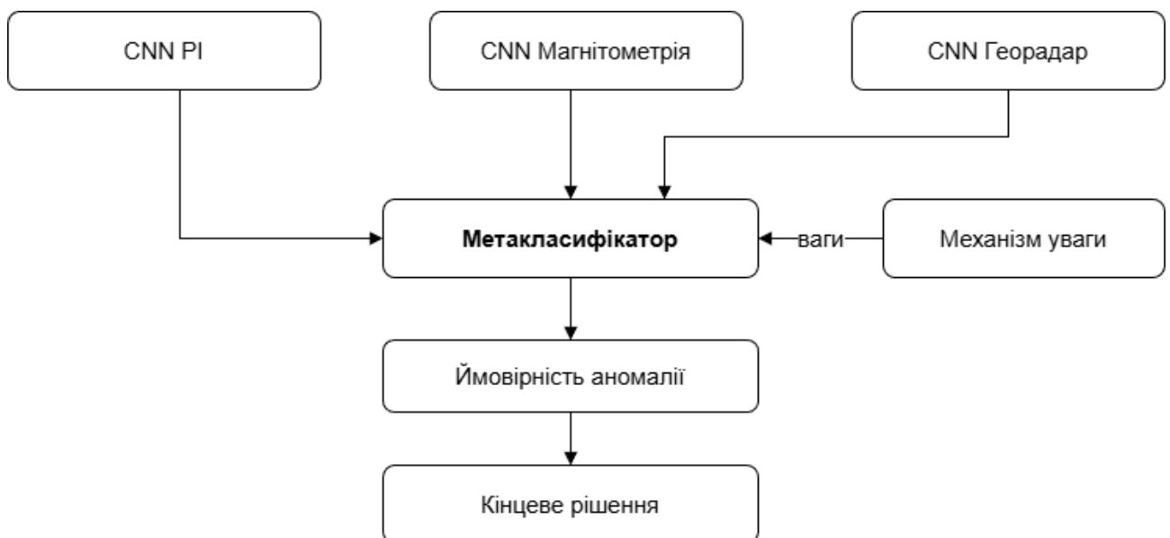
Рисунок 5.8 – Архітектура ансамблевого класифікатора для мультисенсорного виявлення аномалій
