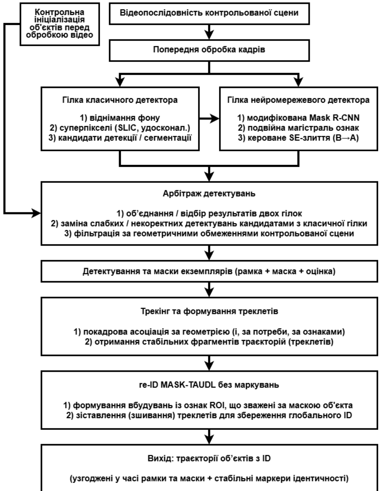
Рисунок 5.2 – Загальна схема інтегрованого конвеєра детектування, трекінгу та наскрізної ідентифікації лабораторних тварин
