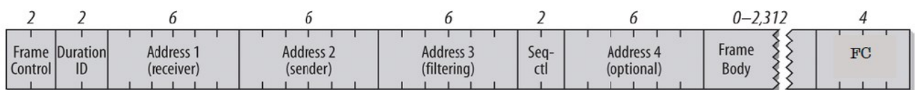
Рисунок 2.1 – Загальна структура фрейму 802.11
