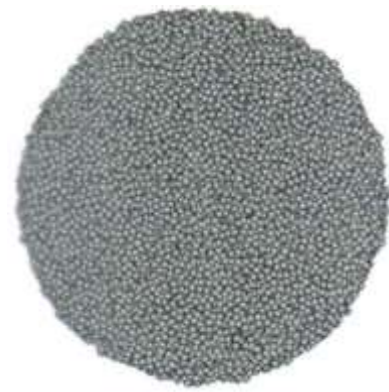
Рисунок 2.4 – Пакування з 500000 монодисперсійних сферичних частинок, отримана способом «центрального» укладання
