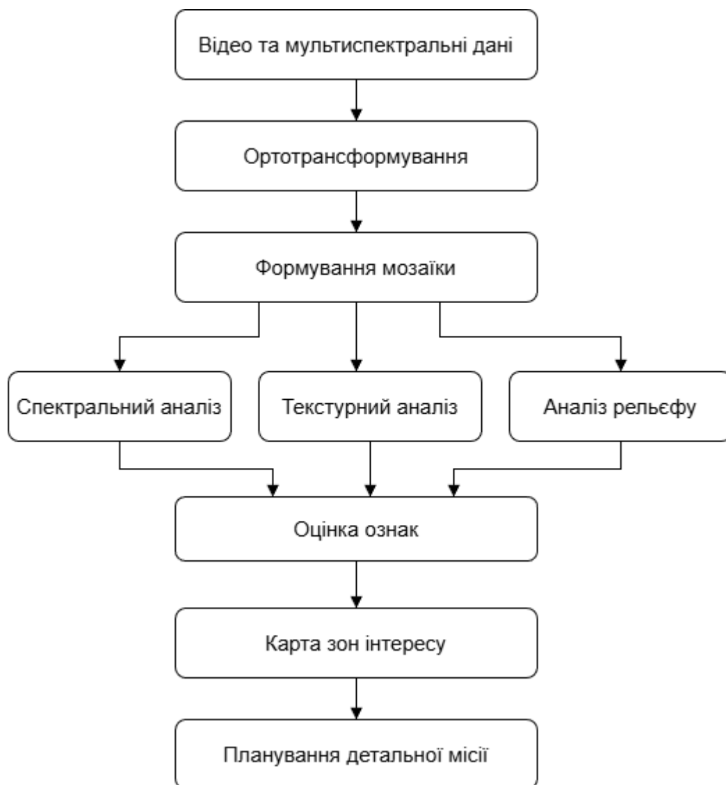
Рисунок 4.2 – Схема попереднього аналізу даних дистанційного зондування
