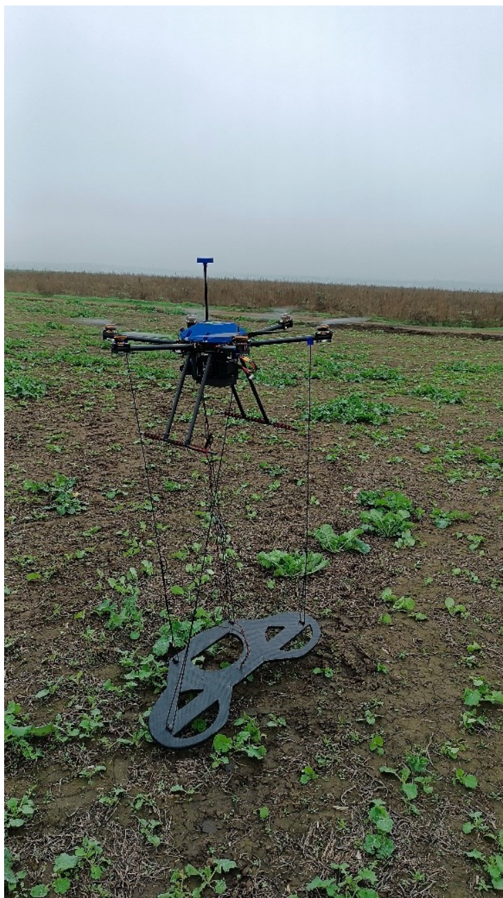
Рисунок 2.4 – Гексакоптер з трикоштовим РІ-датчиком на підвісі [5, 60]
