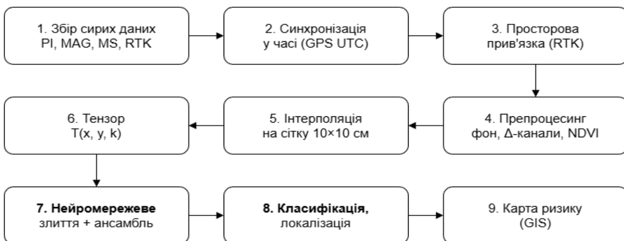
Рисунок 2.17 – Узагальнена схема розробленого конвеєра злиття: від сирих сенсорних потоків до карти ризику
