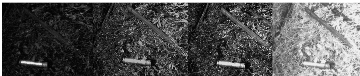
Рисунок 2.6 – Зображення аномалії (гільзи) у різних спектральних діапазонах камери [61]
