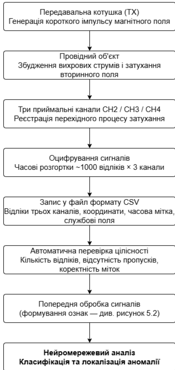
Рисунок 5.1 – Схема проходження даних від сенсора до нейромережевого аналізу
